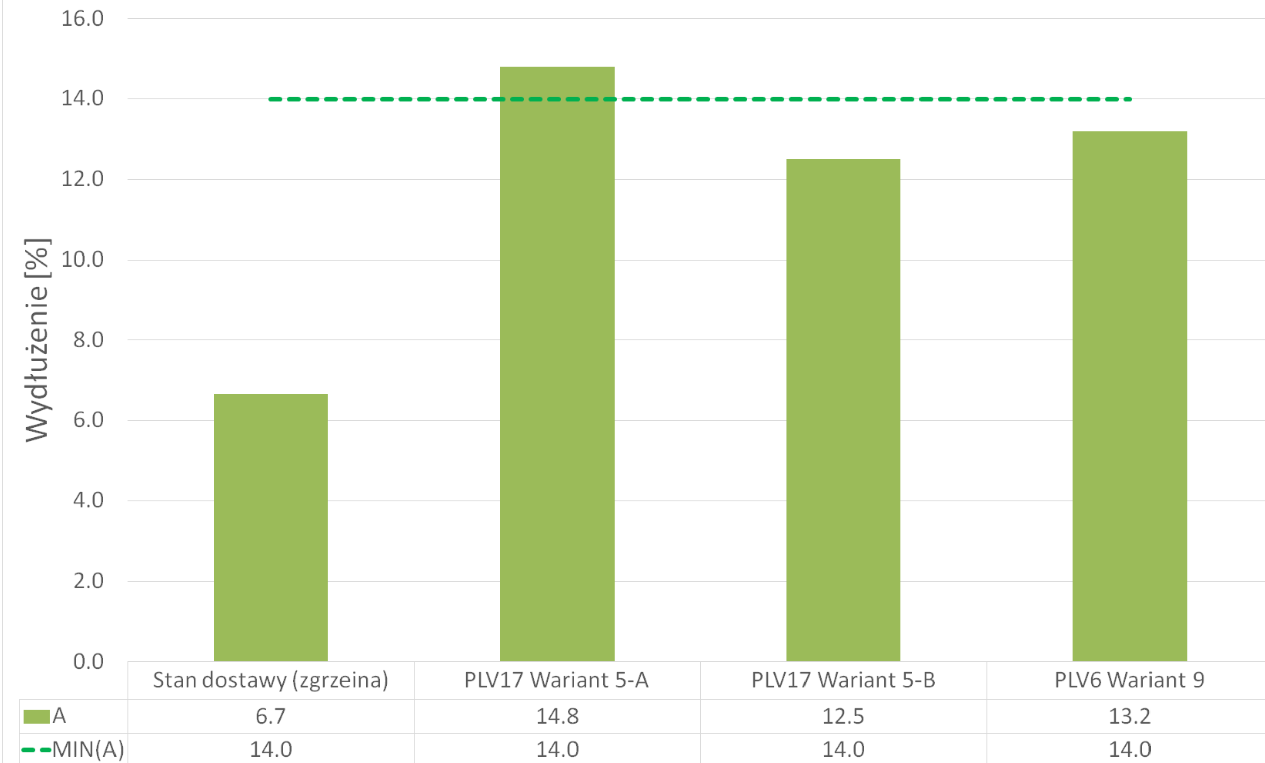
Próbki GLEEBLE z rur ze szwem ze stali w gatunku HCT780X
